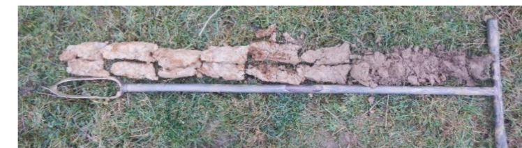
Photo 1 : Exemple de carottage sur une profondeur de 120 cm (source : AEPE-Gingko)
