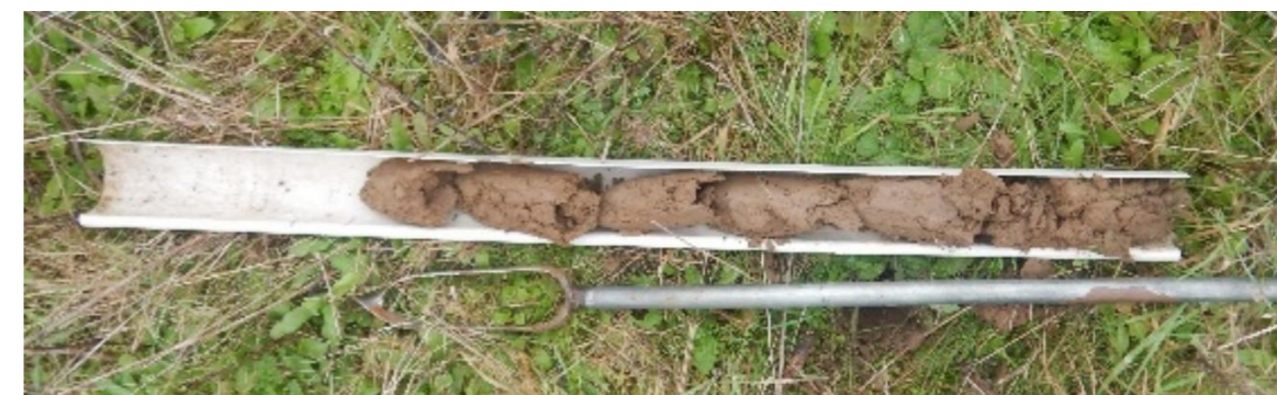
Photo 11 : Exemple de carottage sur une profondeur de 80 cm
