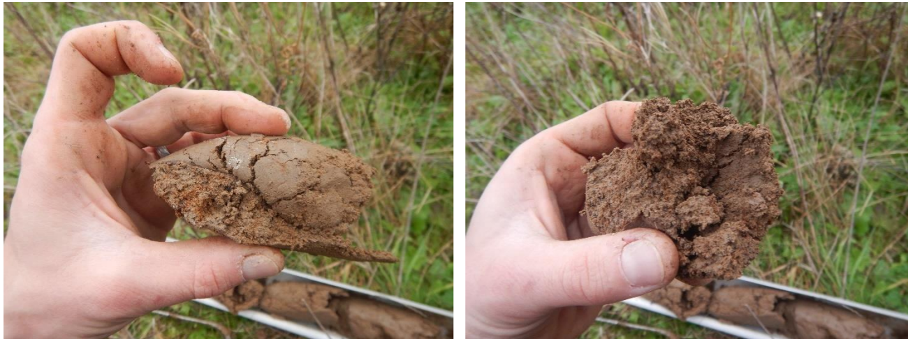
Photos 16 et 17 : Exemples de traces d'hydromorphie observées au nord-ouest
