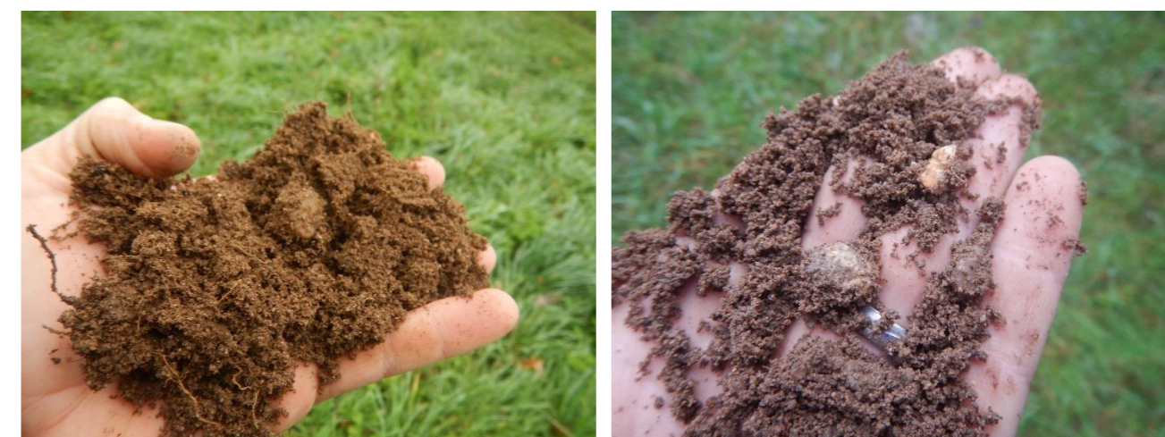
Photos 14 et 15 : Exemples de sols sableux avec des petits cailloux sur la majorité des sondages effectués
