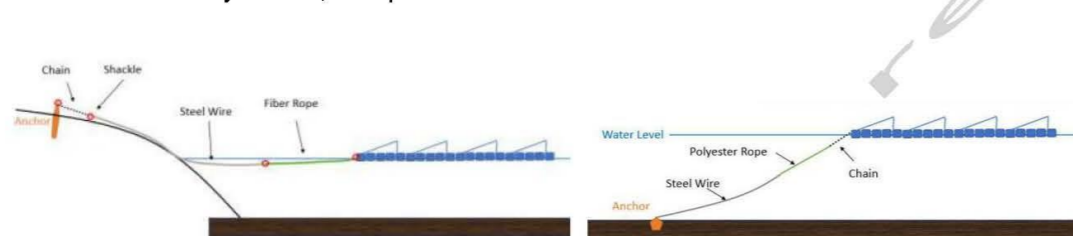
Figure 6 : Schémas d'ancrage en berge (à gauche) et d'ancrage en fond (à droite)
